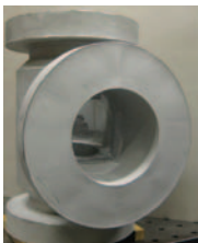
Corps de vanne
